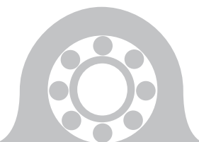
裏ペタのハウジングはユニット底面にゴミがたまるのを防ぎます。
